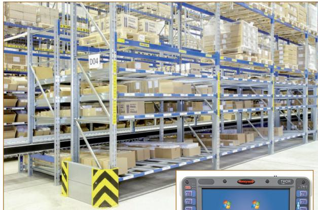
Грузы перемещаются в несколько этапов. Организованы транзитные ячейки для временного хранения грузов, поступающих с производства. Ричтраки перемещают грузы и размещают их в постоянные ячейки хранения. Правила маршрутизации позволяют задать необходимые маршруты для разных видов грузов и распределить их между единицами техники.
